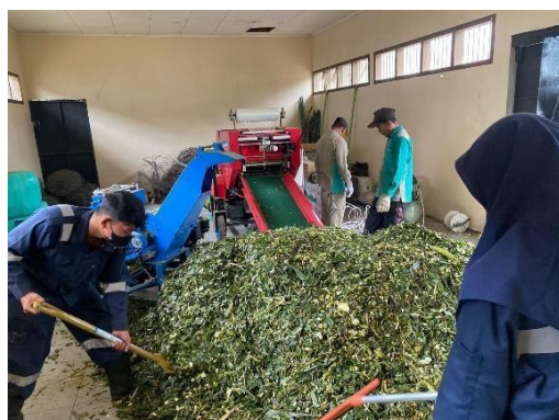
Gambar 17. Pembuatan Silase dengan Silage Baler
