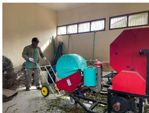
Gambar 17. Pembuatan Silase dengan Silage Baler
